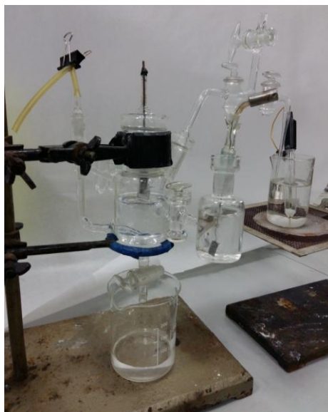
Рис. 15 Трёхэлектродная ячейка с разделёнными электродными пространствами.
